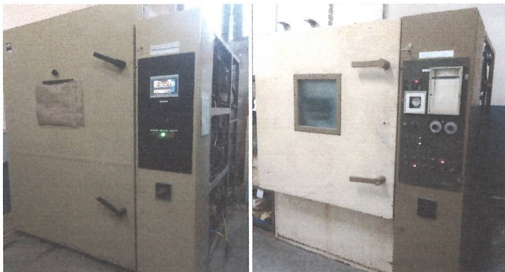
Рисунок 3 – Кліматичні камери для проведення циклічних кліматичних впливів
